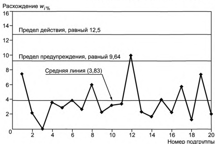
Рисунок В.2 – Карта пределов определения массовой концентрации 2-пропанола ( \text{мг/дм}^3 ) в спирте, полученных в условиях промежуточной прецизионности с изменяющимися факторами «время» и «оператор»
