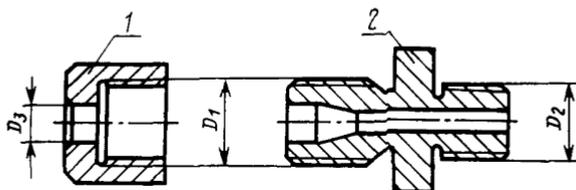
1—колпак распылителя; 2—корпус распылителя
