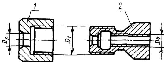
1 — колпак распылителя, 2 — корпус распылителя
