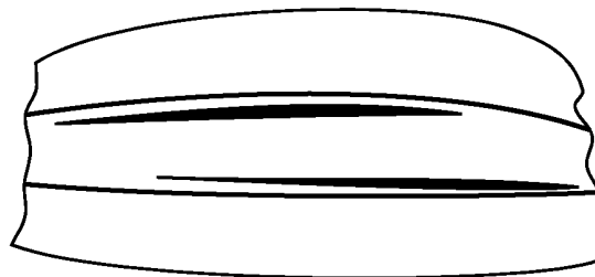
Рисунок И.6 — Часть сварочного шва с трещинами
