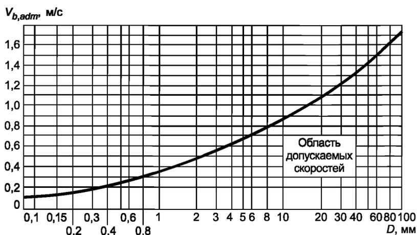
Рисунок В.1 — График допускаемых значений скоростей
