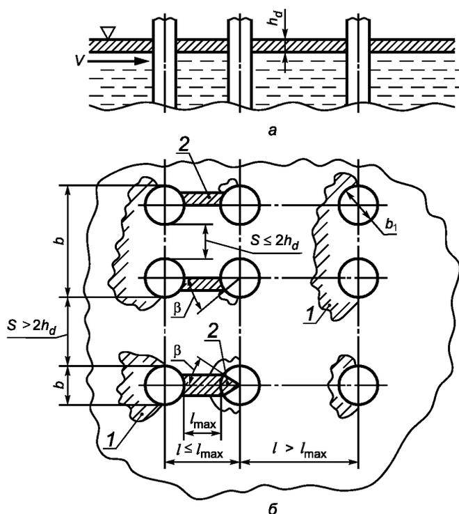
а, б — профиль и план ряда из столбов диаметром  $b_1$
