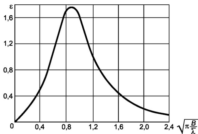
Рисунок Л.3 — График для определения значения  $\varepsilon$
