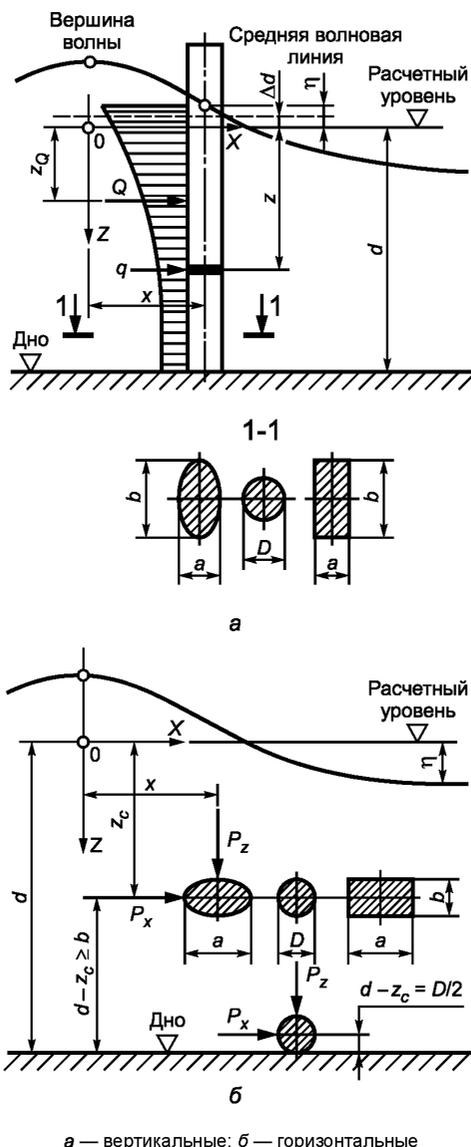
Рисунок 8 — Схемы к определению волновых нагрузок на обтекаемые преграды
