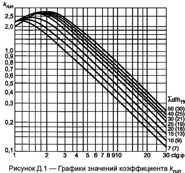
Рисунок Д.1 — Графики значений коэффициента  $k_{run}$
