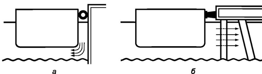
а — сплошная конструкция; б — сквозная конструкция
