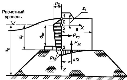
Рисунок 5 — Эпюры давления разбивающихся волн на вертикальную стену
