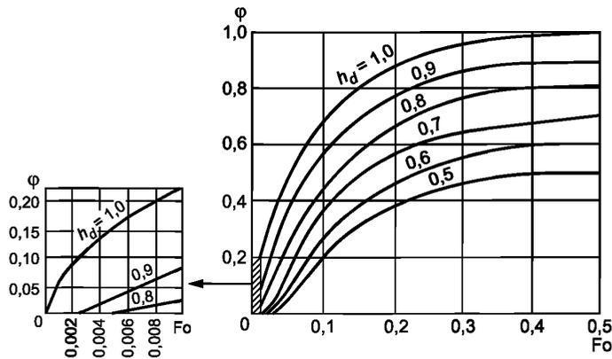
Рисунок 25 — Графики значений коэффициента  $\phi$
