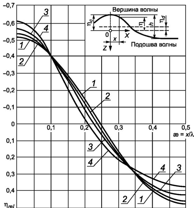
1 — при  $d/\lambda = 0,5$  и  $\lambda/d = 40$ ; 2 — при  $d/\lambda = 0,5$  и  $\lambda/d = 20$ , а также при  $d/\lambda = 0,2$  и  $\lambda/d = 40$ ; 3 — при  $d/\lambda = 0,5$  и  $\lambda/d = 10$ , а также при  $d/\lambda = 0,2$  и  $\lambda/d = 20$ ; 4 — при  $d/\lambda = 0,2$  и  $\lambda/d = 10$
