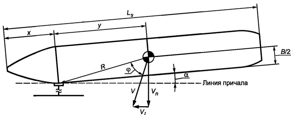
Рисунок М.1 — Схема контакта судна с причалом
