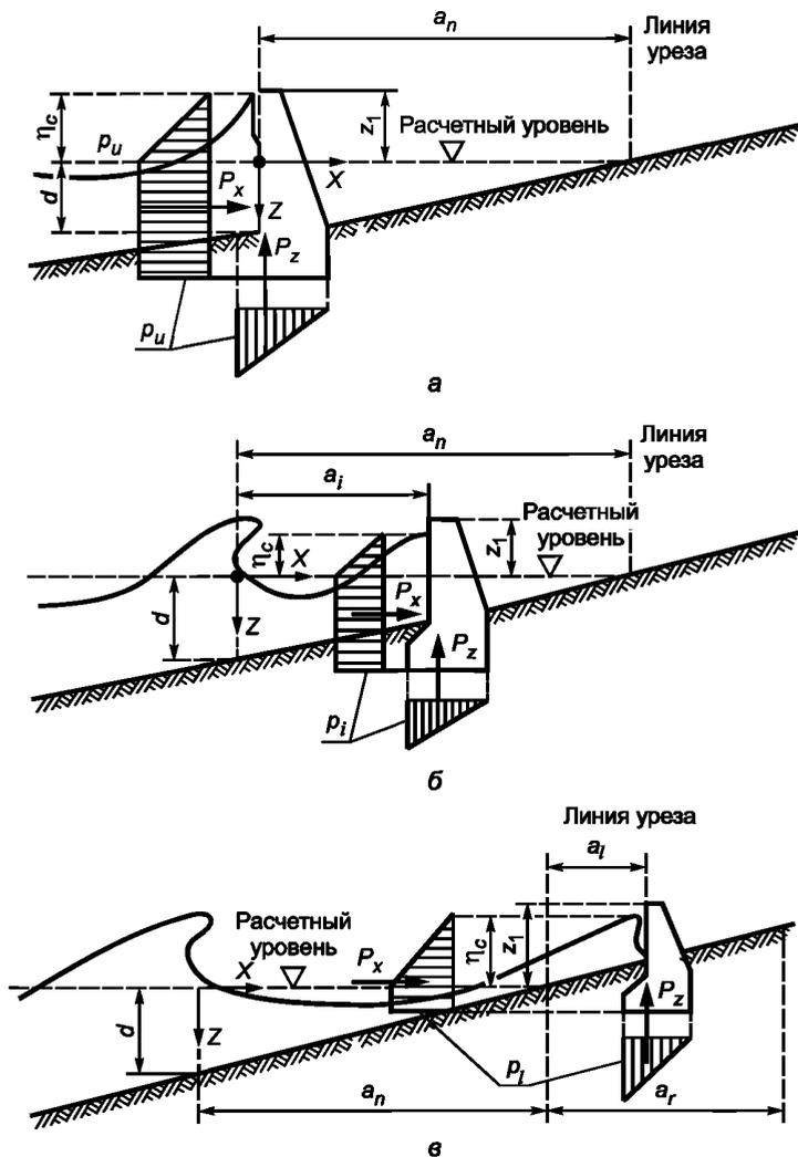
а — в створе последнего обрушения волн; б — в приурезовой зоне; в — за линией уреза
