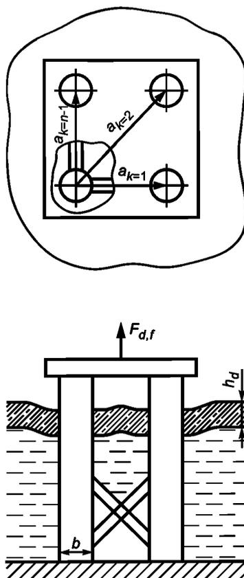
Рисунок 28 — Схема приложения нагрузки к сооружению, состоящему из системы вертикальных колонн, от примерзшего к нему ледяного покрова при повышении уровня воды (при понижении уровня воды сила  $F_{d,f}$  направлена вниз)
