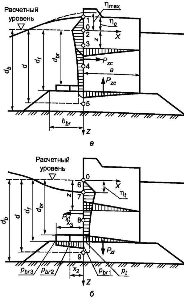
а — при гребне волны; б — при ложбине волны (с эпюрами взвешивающего волнового давления)
