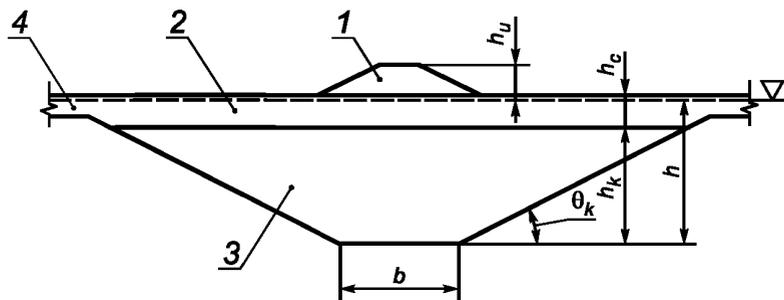
1 — парус; 2 — консолидированный слой; 3 — киль; 4 — ровный лед;  $\theta_k$  — угол киль;  $h_u$  — высота паруса;  $h$  — заглубление киль;  $h_c$  — толщина консолидированного слоя;  $h_k$  — расстояние между нижней частью консолидированного слоя и килем
