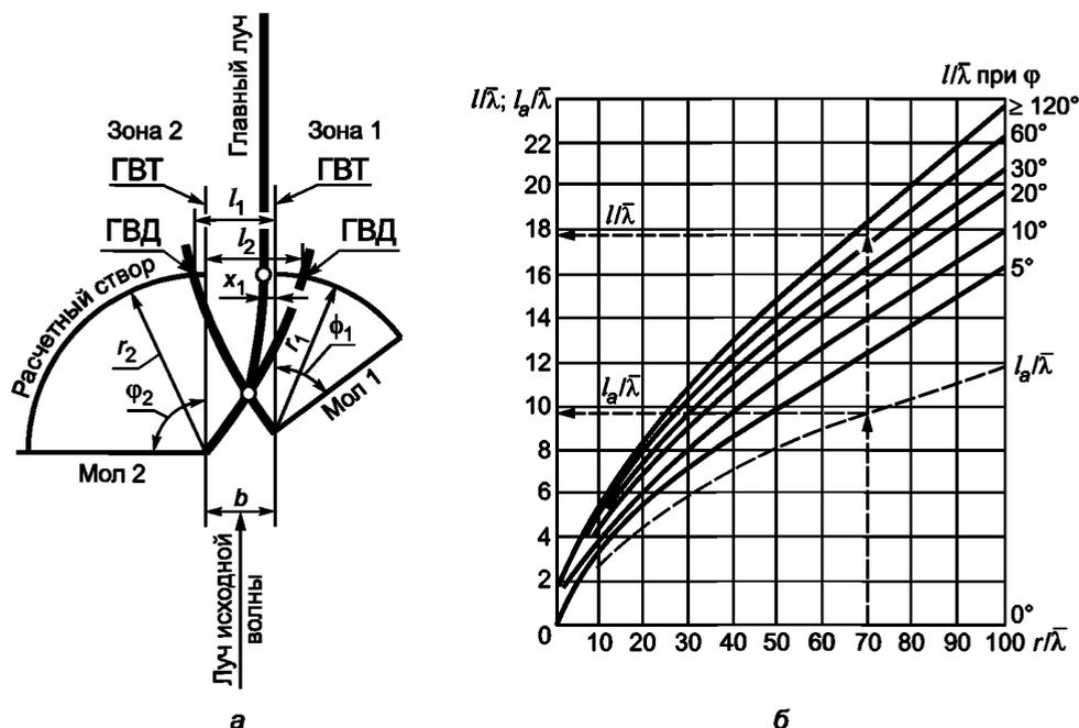
Рисунок А.9 — Схема (а) и графики (б) для определения значений  $I$  и  $I_a$
