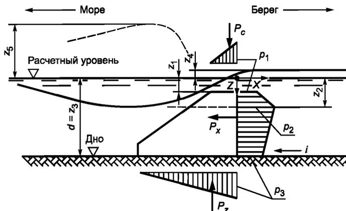
Рисунок 9 — Эпюры волнового давления на подводный волнолом
