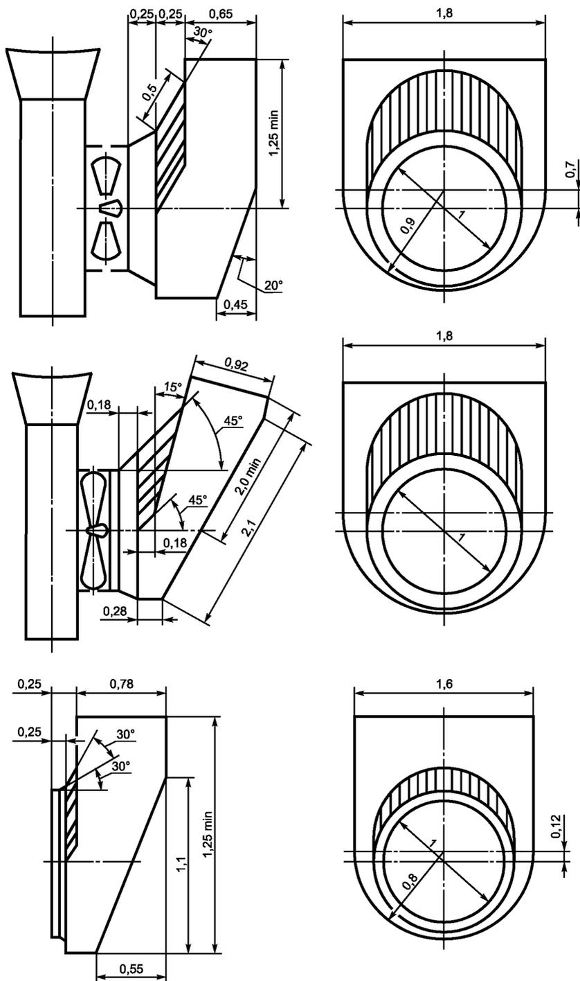
Рисунок 7.3 — Примеры конструкций всасывающего кармана
