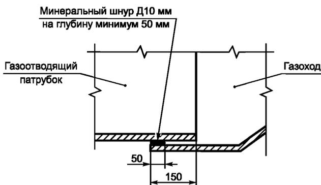
Рисунок 7.2 — Телескопическое соединение газоотводящего патрубка оборудования с газоходом
