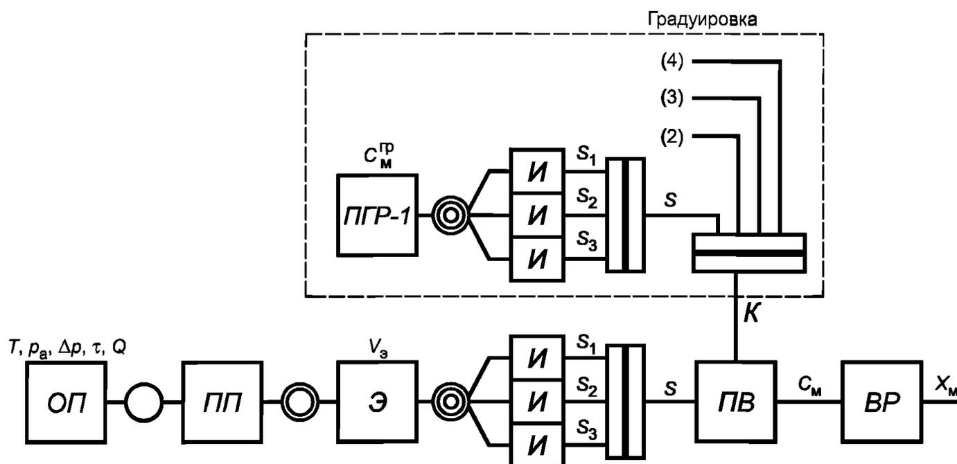
ОП — отбор газовой пробы; при отборе измеряют параметры пробы: температуру  $T$ , °С; атмосферное давление  $p_a$ , кПа; разрежение  $\Delta p$ , кПа; время отбора  $\tau$ , мин; объемный расход  $Q$ ,  $\text{дм}^3/\text{мин}$ .
