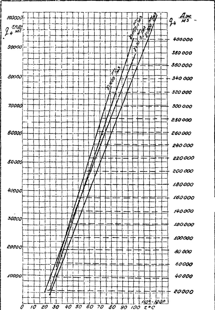
Рис.3. Графики количества тепла, необходимого для нагрева раствора до заданной температуры. Начальная температура воды 15 $^{\circ}C$ , начальная температура растворов 20 $^{\circ}C$
