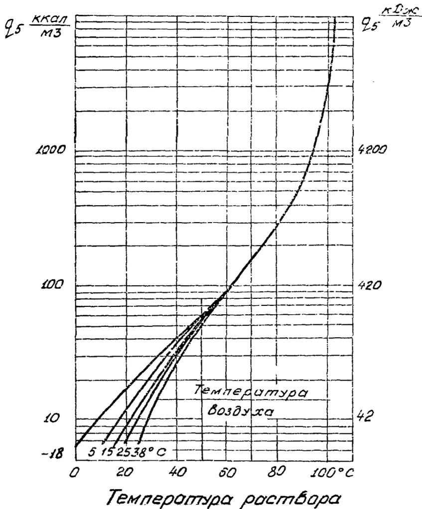
Рис.4. График определения удельного расхода тепла на нагрев 1 м<sup>3</sup> сжатого воздуха
