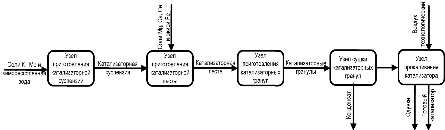
Рисунок 5.6 — Схема производства железопоташевых катализаторов
