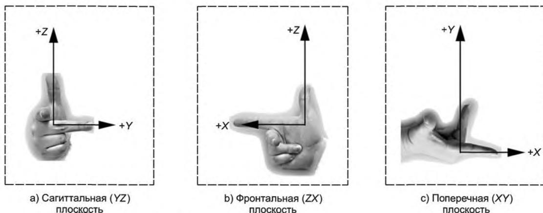
Рисунок 8 — Три оси и образованные ортогональные плоскости
