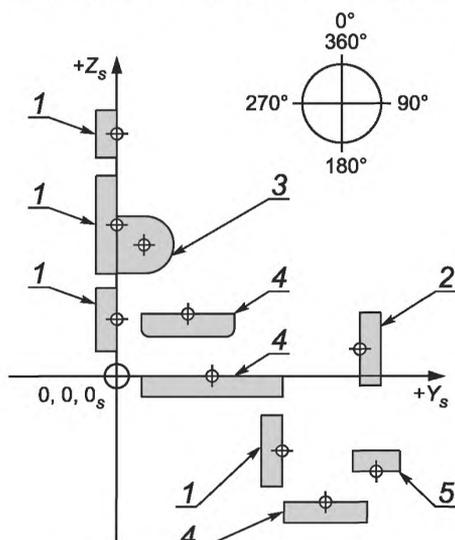
1 — задняя опора (ЗО); 2 — передняя опора (ПО); 3 — боковая опора (БО); 4 — нижняя опора (НО); 5 — верхняя опора (ВО)
