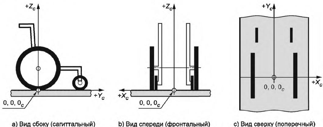
Рисунок 10 — Положение общей нулевой точки, определяемой конфигурацией рамы кресла-коляски
