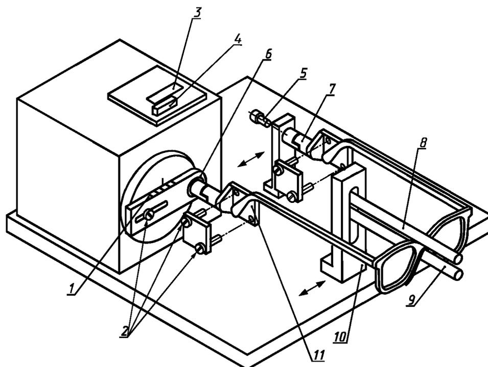
1 — шкала амплитуды смещения оправы; 2 — крепежные винты; 3 — окно счетчика; 4 — контрольный выключатель; 5 — фиксирующий винт  $L$ ; 6 — шариковый подшипник; 7 — универсальный шарнир; 8 — регулируемый ограничитель моста; 9 — регулируемый узел поддержки моста; 10 — регулируемая стойка для различных размеров очковых оправ; 11 — подвижный зажим
