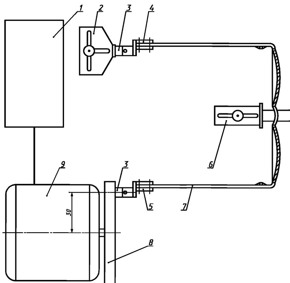
1 — контрольная панель и счетчик; 2 — регулятор зажима заушника; 3 — универсальный шарнир; 4 — фиксированный зажим *R*; 5 — подвижный зажим *M*; 6 — узел поддержки моста; 7 — испытуемый образец; 8 — вращающийся диск; 9 — приводной мотор
