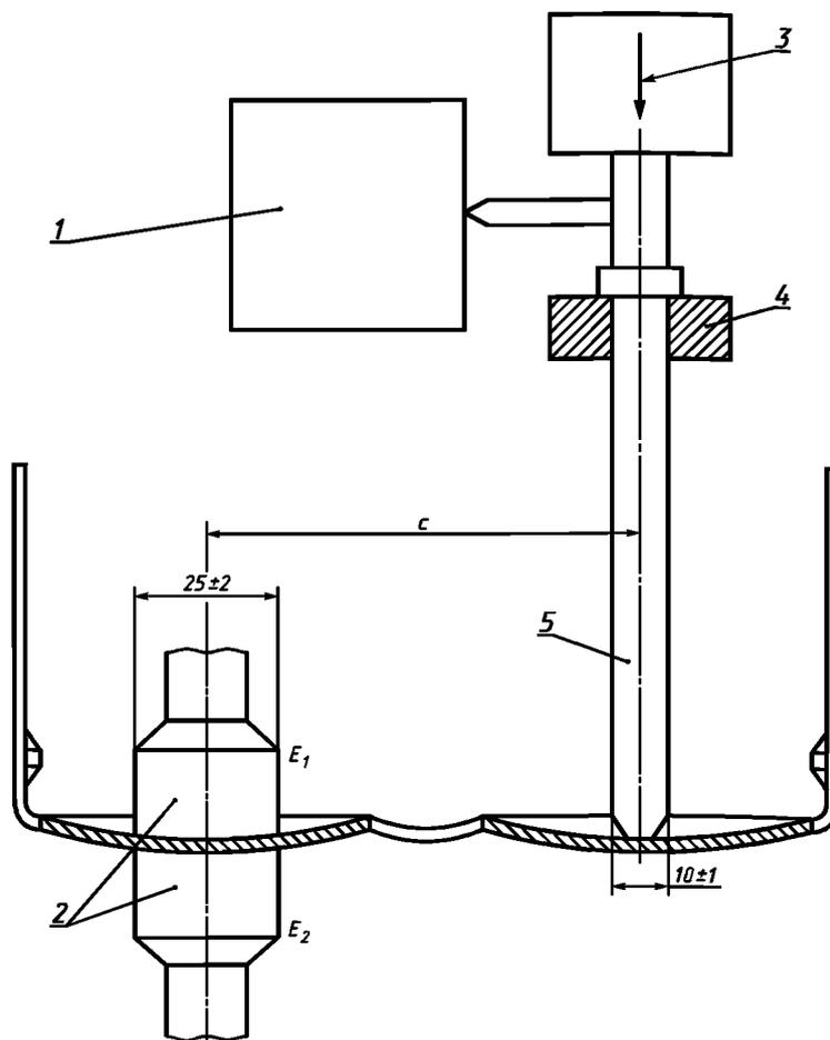
1 — измерительный прибор; 2 — кольцевая струбица; 3 — направление и точка приложения силы (наибольшая — 5 Н); 4 — направляющее кольцо; 5 — давящий штырь;  $E_1$  и  $E_2$  — контактные поверхности
