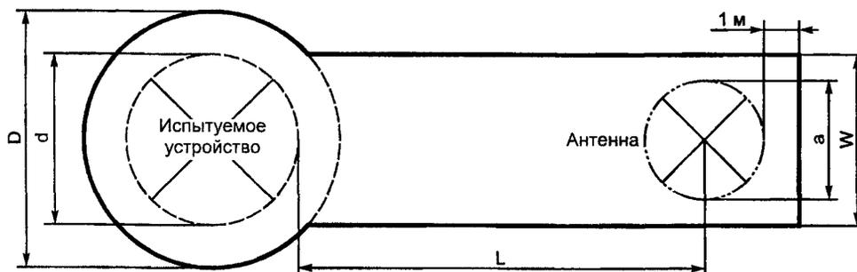
$D = (d + 2)$  м, где  $d$  — максимальный размер испытуемого устройства;
