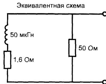
Рисунок 6 — Эквивалентная схема и модуль входного полного сопротивления эквивалента сети
