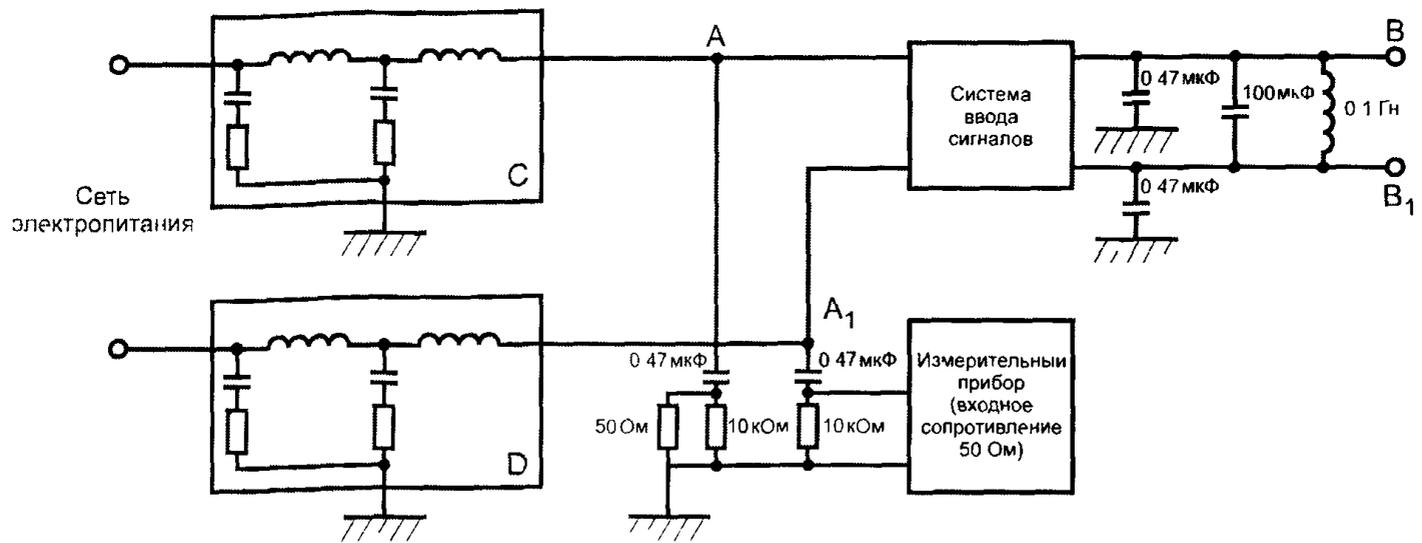
В, В<sub>1</sub> — точки измерения уровней выходных сигналов в электрической сети потребителя электрической энергии, С, D — эквиваленты сети (см рисунок 5)
