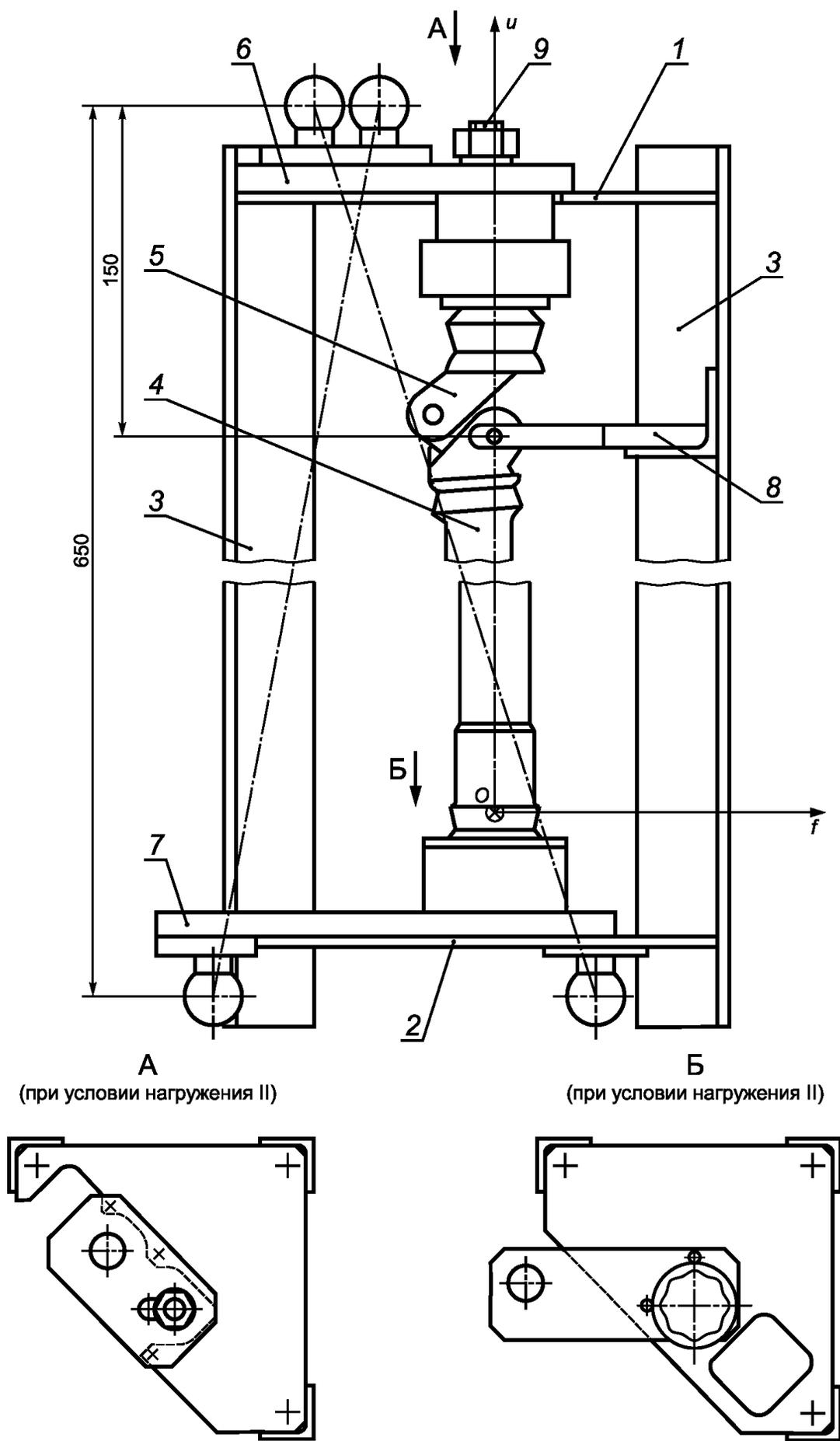
1 — верхняя пластина; 2 — нижняя пластина; 3 — стойки; 4 — модель полной конструкции; 5 — коленный узел; 6 — верхний рычаг; 7 — нижний рычаг; 8 — пластина с соосными иглами; 9 — винт
