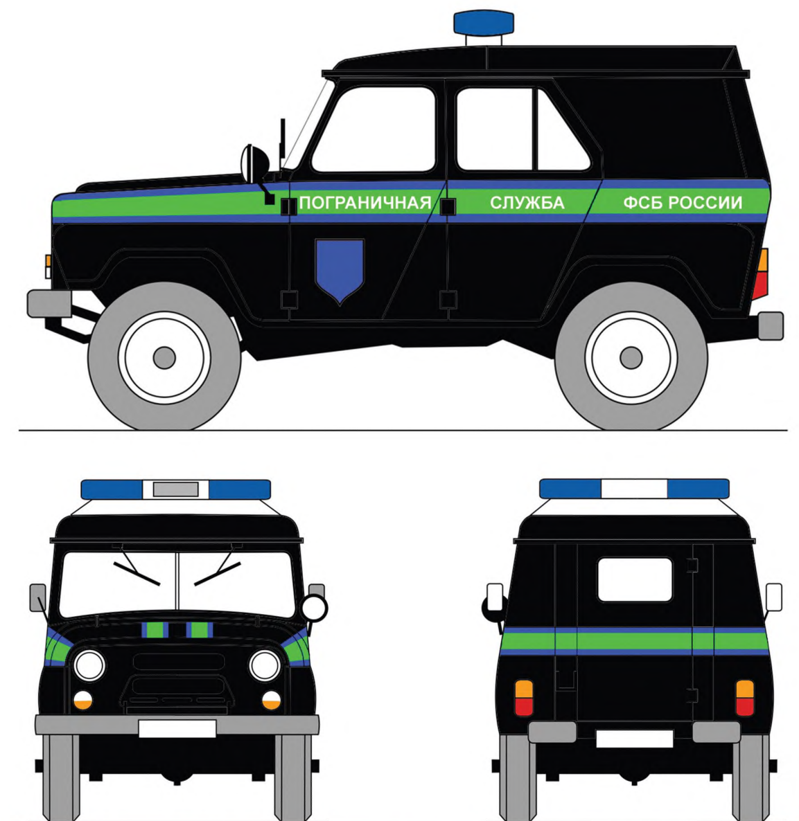
Рисунок А.42 — Цветографические схемы автомобилей органов Федеральной службы безопасности, используемых для проведения неотложных действий по пресечению нарушений режима государственной границы Российской Федерации
