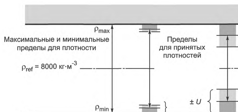
Рисунок В.3 — Допуски для плотности и пределы при проверке в зависимости от неопределенности измерений
