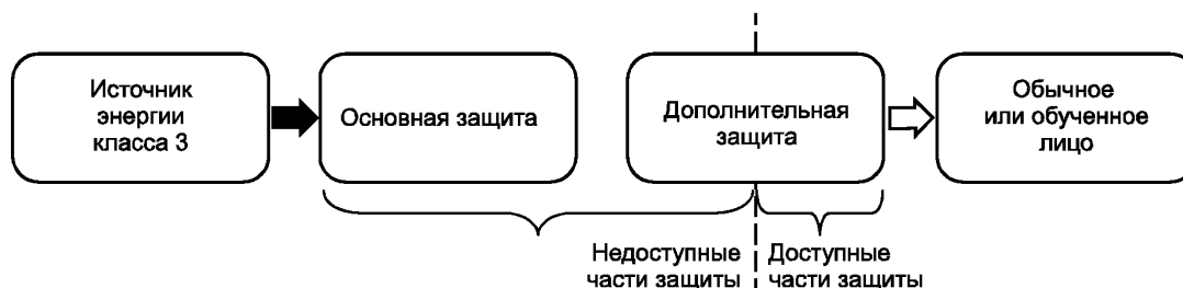
Рисунок 21 — Изображение доступных и недоступных частей дополнительной защиты
