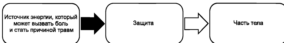
Рисунок 2 — Трехблочная модель защиты
