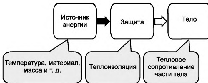
Рисунок 8 — Схема и модель защиты от тепловых травм
