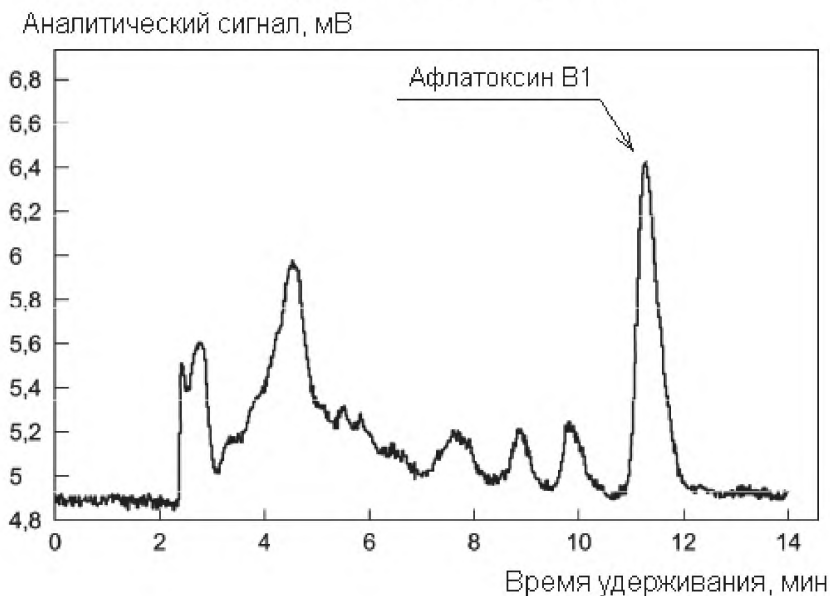
Рисунок А.1 – Пример типичной хроматограммы при определении афлатоксина В 1 в продукте для питания детей раннего возраста с применением очистки экстракта на иммуноаффинной колонке.
