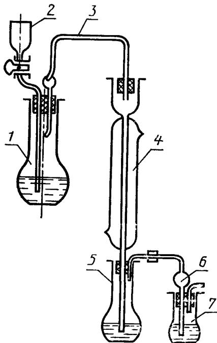
1 — перегонная колба; 2 — капельная воронка; 3 — трубка с гидрозатвором; 4 — холодильник; 5 — приемник; 6 — гидрозатвор; 7 — контрольный приемник
