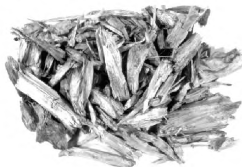
Измельченное топливо (дробление тупым инструментом)
