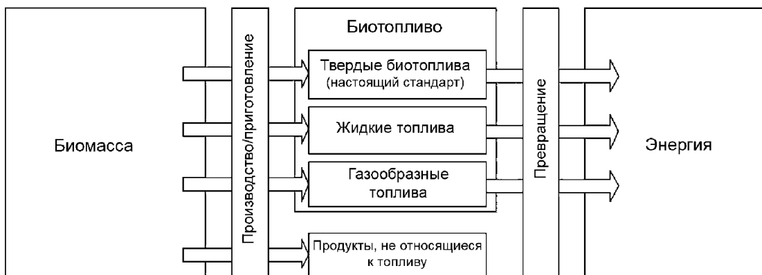
Рисунок 1 — Цепочка преобразований биомасса — биотопливо — энергия с указанием области применения настоящего стандарта
