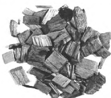
Щепа (резка острым инструментом)
