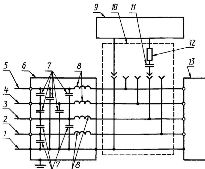
1, 2, 3, 4, 5 — защитный, нейтральный и фазные провода сети электропитания соответственно; 6 — устройство развязки; 7 — конденсаторы развязки; 8 — индуктивности развязки; 9 — ИГ МИП; 10 — устройство связи; 11 — конденсатор связи; 12 — резистор связи; 13 — ИТС
