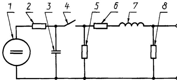
1 — источник высокого напряжения; 2 — зарядный резистор, 3 — зарядный конденсатор; 4 — коммутирующий ключ, 5, 8 — резисторы, формирующие длительность импульса; 6 — резистор, определяющий внутреннее сопротивление; 7 — индуктивность, формирующая длительность фронта импульса
