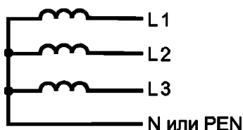
Рисунок 5 – Трехфазная четырехпроводная электрическая цепь
