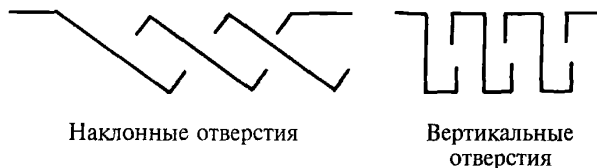
Рисунок 3 — Примеры разрезов отверстий, препятствующих вертикальному доступу
