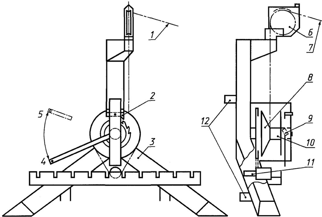
1 — желобочное колесо; 2 — стопор барабана; 3 — силовая передача; 4 — свободная размотка; 5 — силовая размотка; 6 — шкив; 7 — канат; 8 — дисковая муфта; 9 — полумуфта; 10 — барабан; 11 — приводной вал; 12 — трехточечное крепление
