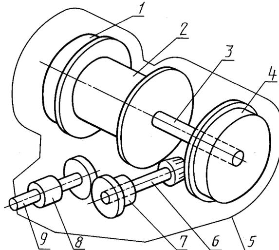
1 — фрикционная муфта; 2 — барабан лебедки, реборда, бочка; 3 — вал барабана;
