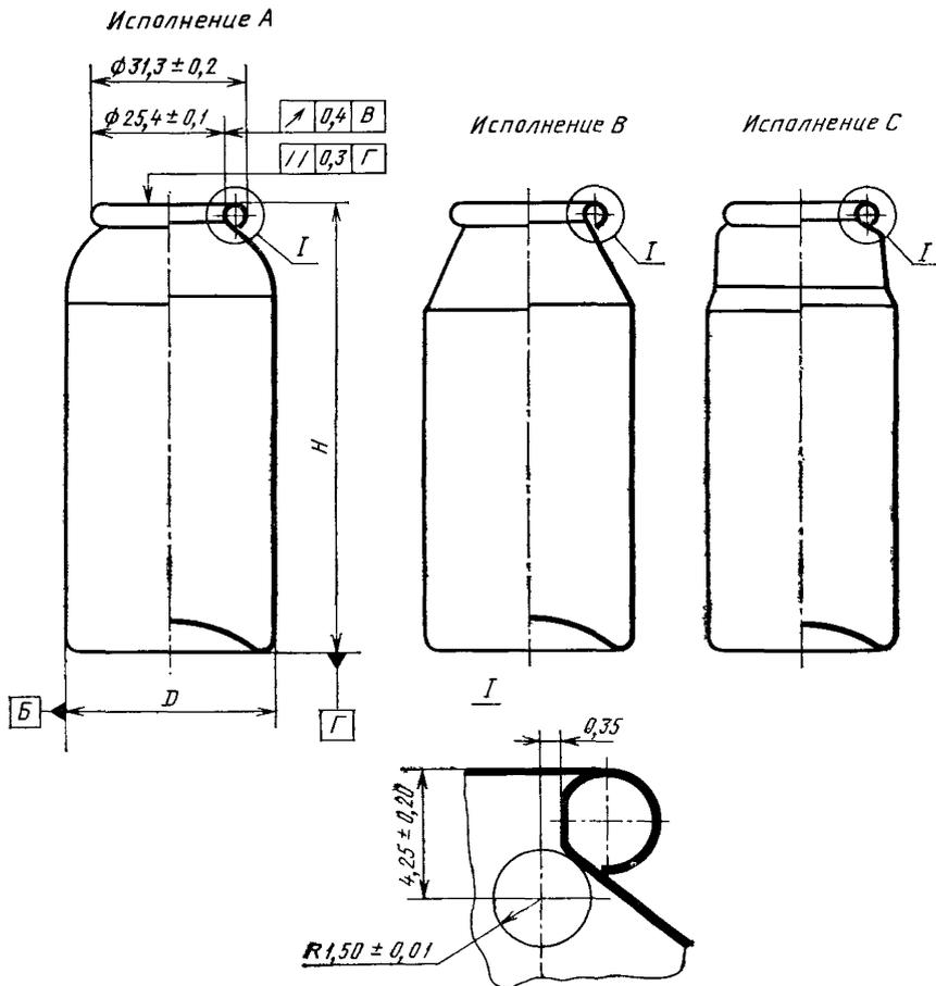
Примечание. Размеры  $R(1,50 \pm 0,01)$  и  $0,35$  не являются контролируемыми и даны для изготовления инструмента.
