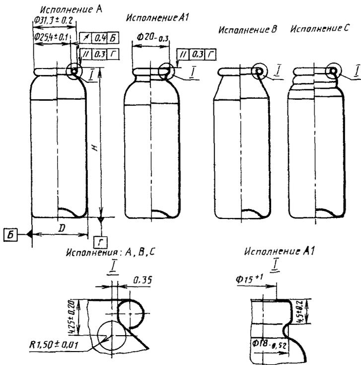
Примечание. Размеры  $R(1,50 \pm 0,01)$  и  $0,35$  не являются контролируемые и даны для изготовления инструмента.
