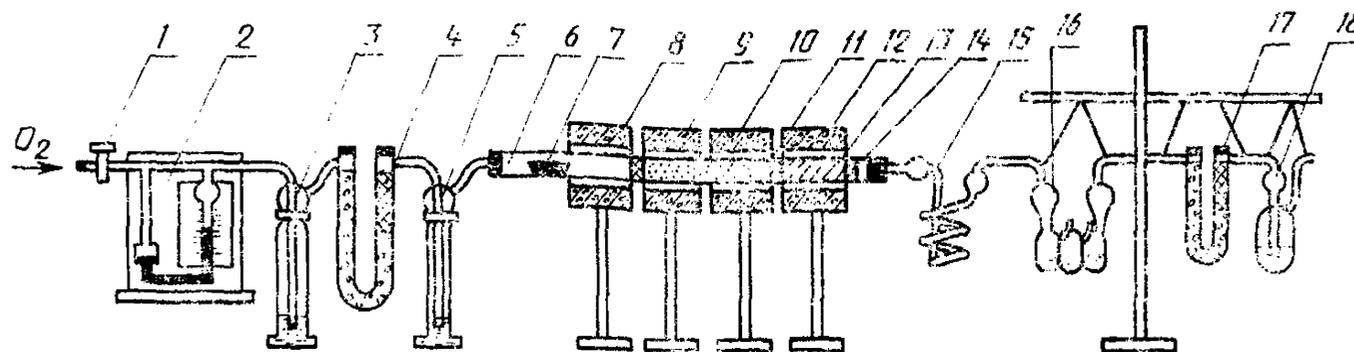
1 — кран тонкой регулировки на линии подачи кислорода; 2 — реометр для измерения скорости тока кислорода; 3, 4, 5 — система очистки кислорода; 6 — трубка для сжигания; 7 — лодочка с навеской; 8, 9, 10, 12 — электропечи типа СУОЛ 0,25.1.1/12МР; 11 — гранулированный оксид меди или оксид хрома; 13 — плавный хромовокислый свинец; 14 — пробка из медной сетки или из прокаленного волокнистого асбеста; 15, 16, 17 — поглотительная система; 18 — счетчик пузырьков с концентрированной серной кислотой
