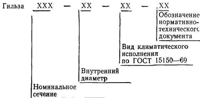
**Изменение № 1 ГОСТ 23469.1—82 Гильзы соединительные медные для кабелей до 10 кВ. Конструкция и размеры**
