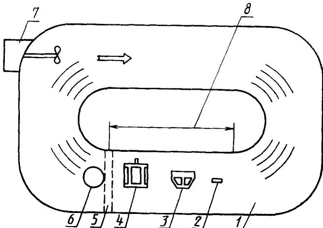
1 — аэродинамическая труба; 2 — измеритель температуры; 3 — место установки испытываемого извещателя; 4 — контрольная извещательная камера; 5 — место установки нагревательного элемента; 6 — место ввода продуктов горения (аэрозоля); 7 — вентилятор; 8 — измерительный участок; стрелками показано направление движения контролируемой среды
