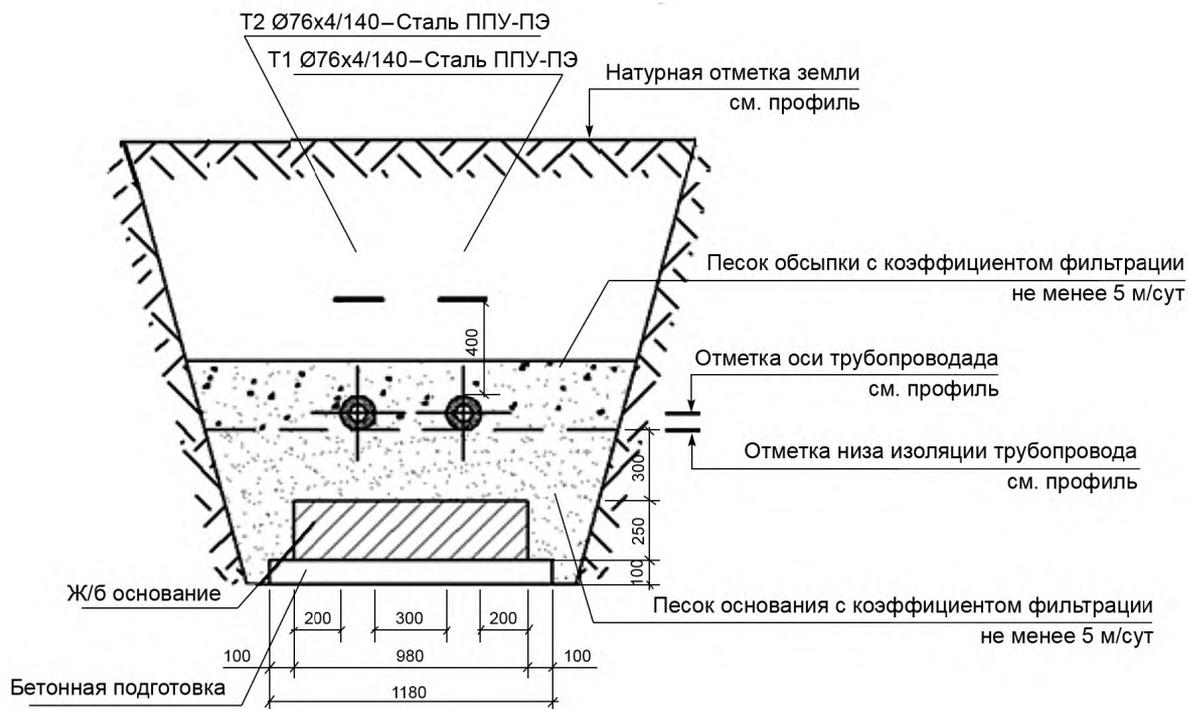
Рисунок Г.5 — Поперечный разрез. Бесканальная прокладка в траншее по бетонной подготовке
