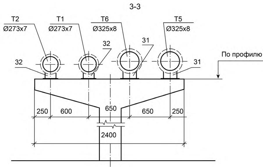
Рисунок Г.2 — Поперечный разрез при надземной прокладке
