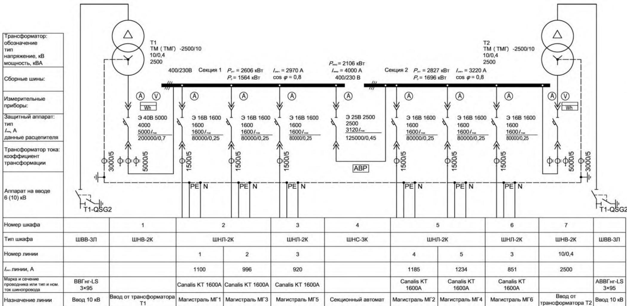
Рисунок А.1 — Пример выполнения принципиальной схемы КТП
