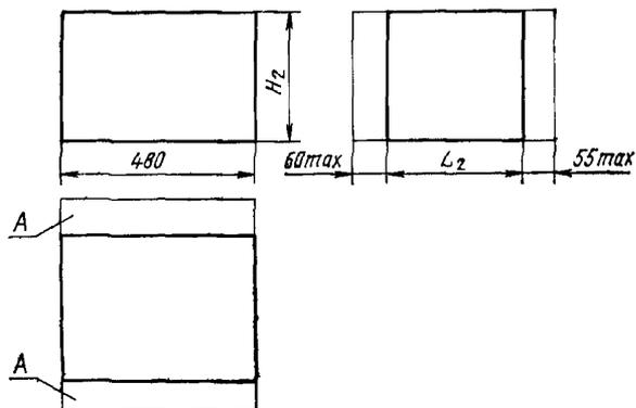
A — зона размещения элементов коммутации, электрического монтажа и внешних конструктивных элементов
