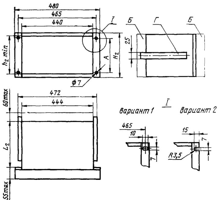
Б — зона размещения элементов коммутации, электрического монтажа и внешних конструктивных элементов. Допускается изготавливать каркасы без направляющих
