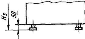
А — накладная дверь;  $a=50$ ; 160 мм (160— для шкафов в пылезащищенном и водозащищенном исполнениях)
