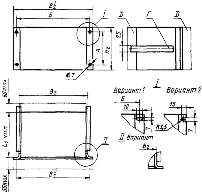
$D$  — зона размещения элементов коммутации, электрического монтажа и внешних конструктивных элементов. Дпускается изготовлять каркасы без направляющих  $\Gamma$
