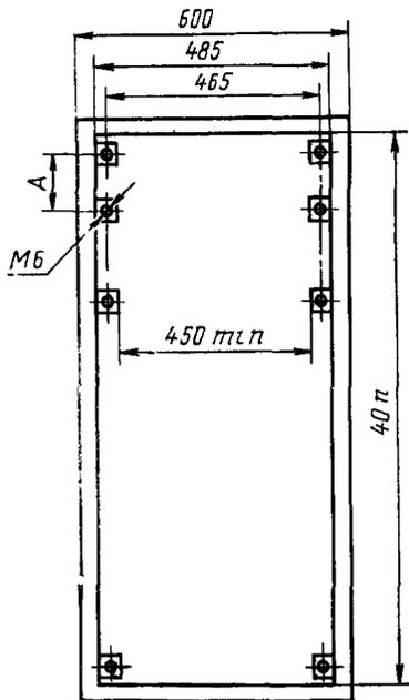
A — размер устанавливают в зависимости от межцентрового расстояния крепежных отверстий лицевой панели каркаса по вертикали плавным перемещением вспомогательного изделия — направляющей;
