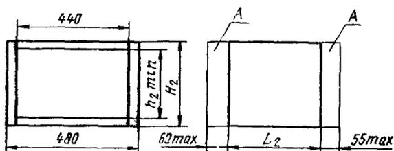
А — зона размещения элементов коммутации, электрического монтажа и внешних конструктивных элементов
