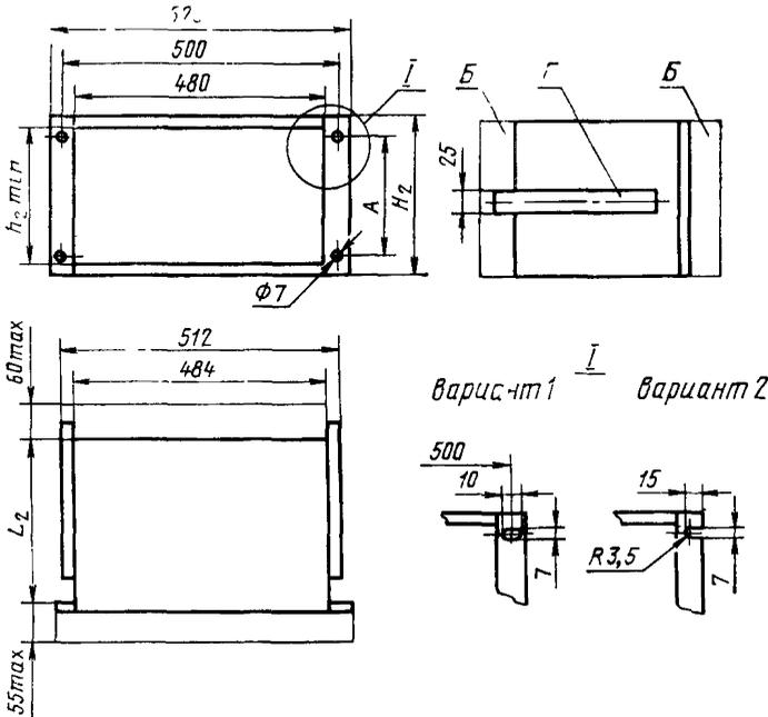
Б — зона размещения элементов коммутации, электрического монтажа и внешних конструктивных элементов. Допускается изготавливать каркасы без направляющих Г
