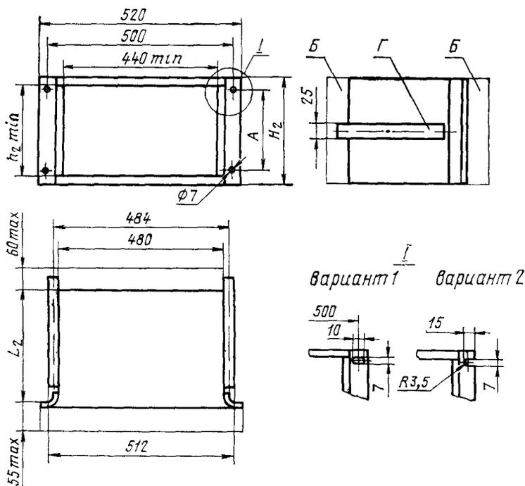
**Б** — зона размещения элементов коммутации, электрического монтажа и внешних конструктивных элементов. Допускается изготавливать каркасы без направляющих **Г**
