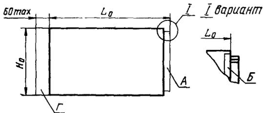
А — зона размещения печатной вставки; Б — зона размещения накладной части соединителя; Г — зона размещения элементов настройки и регулирования
