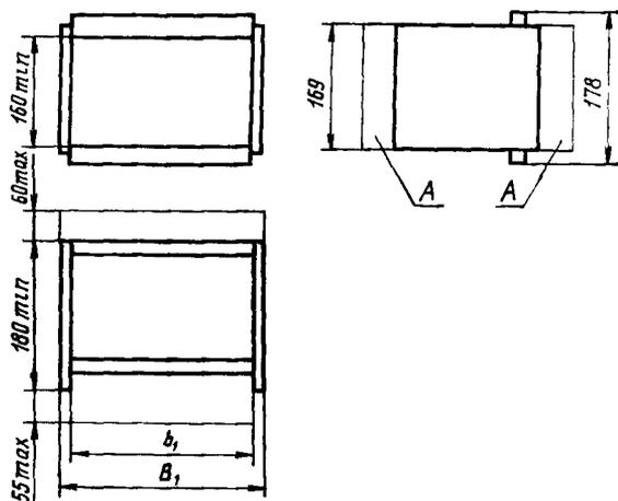
**A** — зона размещения элементов коммутации, электрического монтажа и внешних конструктивных элементов
