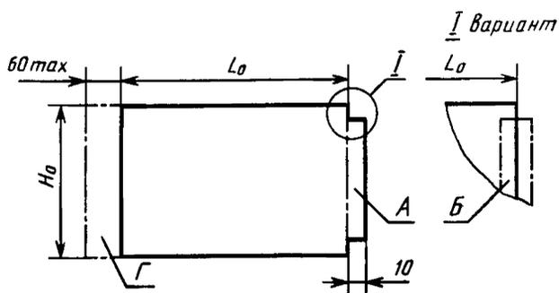
А — зона размещения печатной вставки; Б — зона размещения накладной части соединителя; Г — зона размещения элементов настройки и регулирования
