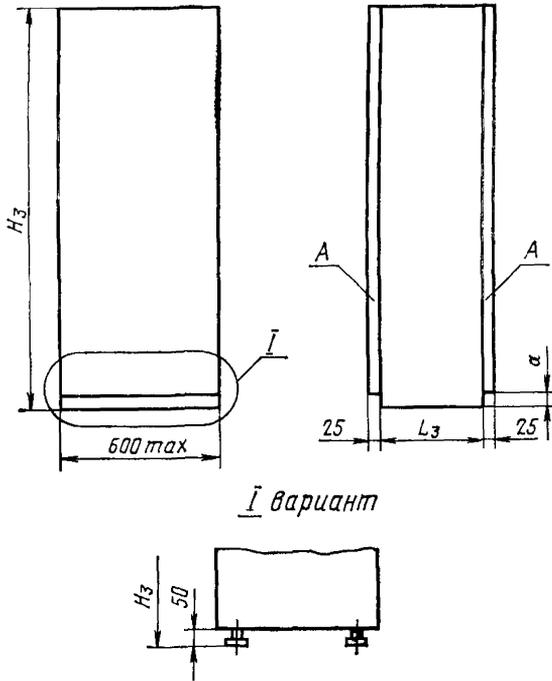
A — накладная дверь (устанавливают при необходимости);  $a=50; 160$  мм (160 — для стоек в пылезащищенном и водозащищенном исполнениях)
