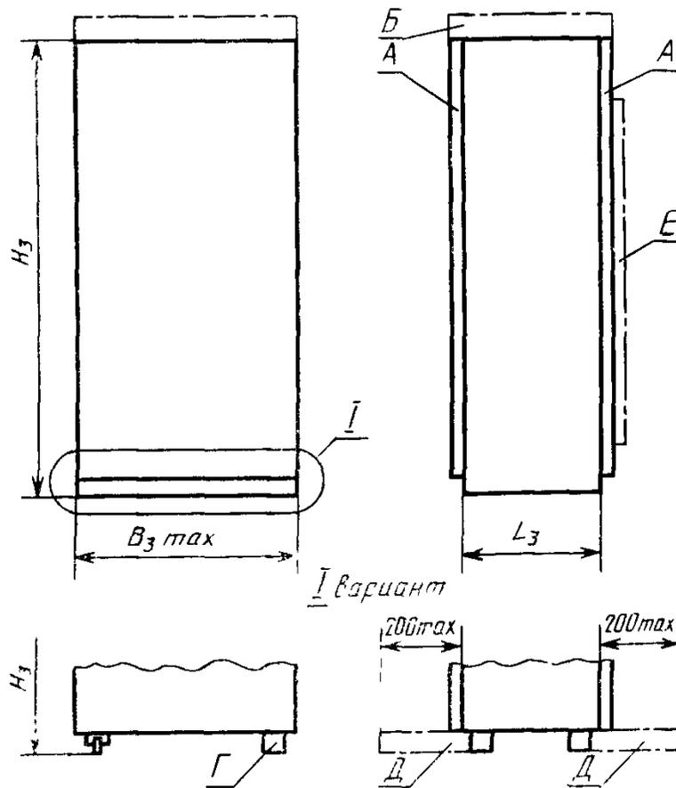
$A$  — дверь;  $B$  — зона размещения рым-болтов, вводов и других конструктивных элементов;  $\Gamma$  — опора (колесо);  $D$  — зона, которая может быть занята дополнительной опорой  $E$  — зона, где допускается размещение дополнительных конструктивных элементов
