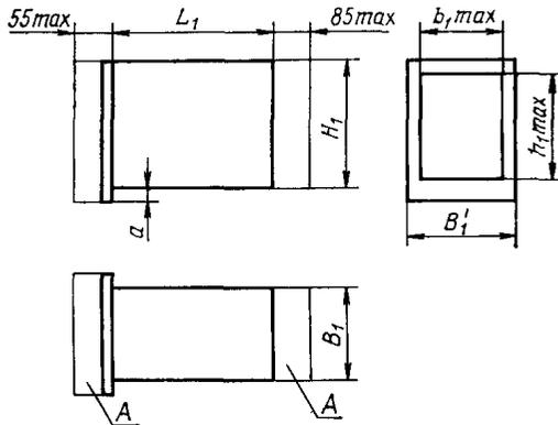
$a=0; 2,5$  мм;  $A$  — зона размещения элементов коммутации, электрического монтажа и внешних конструктивных элементов. Допускается уменьшать размер  $B'1$  до  $B1$
