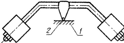
1 — испытуемый образец; 2 — сфера  $R(2,5 \pm 0,1)$  мм
