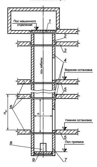
1 — плита перекрытия над шахтой лифта; 2 — верхний блок; 3 — чердачное перекрытие; 4 — средние блоки; 5 — лестничные площадки; 6 — междуэтажные перекрытия; 7 — нижний блок; 8 — тумба под буфер кабины; 9 — плита пола приямка;  $H_{\rm эт}$  — высота этажа здания
