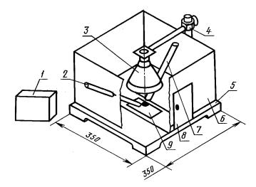
Установка для определения летучих и нелетучих веществ состоит из инфракрасной лампы (3), укрепленной на штативе (4) над подставкой (5), покрытой асбестом и огороженной экраном (6), изготовленным из материала, обеспечивающего теплоизоляцию (температура наружных стенок не должна превышать 50 °C).
