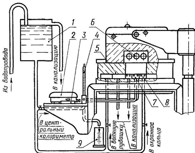
1 — водонапорный бак; 2 — милливольтметр; 3 — переключатель; 4 — термометр Б-IV № 2; 5 — водяная рубашка; 6 — электронагреватели; 7 — калориметр; 8 — охранный кольцо; 9 — измерительный цилиндр.
