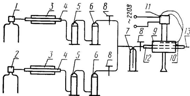
второй абзац. Заменить слова: «электрической трубчатой печи 9 с сопротивлением, позволяющим поддерживать температуру до 1200 °С; термопары платина-платинародиевой 10; гальванометра 11» на «электрической печи 9, позволяющей получать температуру до 1200 °С; системы регулирования с платина-платинародиевой термопарой, обеспечивающей поддержание температур в печи с погрешностью не более указанной в табл. 1»;
