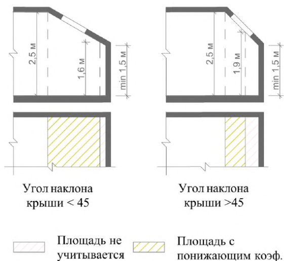
Рисунок 4.1 – Вычисление площади в зависимости от угла наклона потолка
